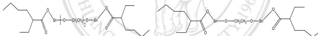
Bis (tin(II) octoate) diethylene glycol [Sn(Oct)] 2 DEG
