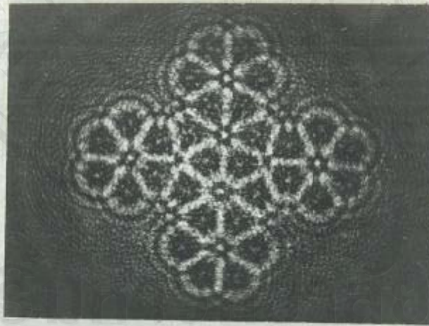
รูปที่ 4.28 ภาพแสดงรูปแบบการเลี้ยวเบนเฟรสเนล ซึ่งเกิดจากตัวอย่าง ที่มีโครงสร้างเป็นโมเลกุลอุมคคคของ diphenylene naphthalene ห่างจากตัวอย่าง 24.45 ซม. โดยใช้ เลนส์ขนานทางยาวโฟกัส 10 ซม. ขยายรูปแบบการเลี้ยวเบน ระยะวัตถุ 13.55 ซม. ระยะภาพ 38 ซม.
