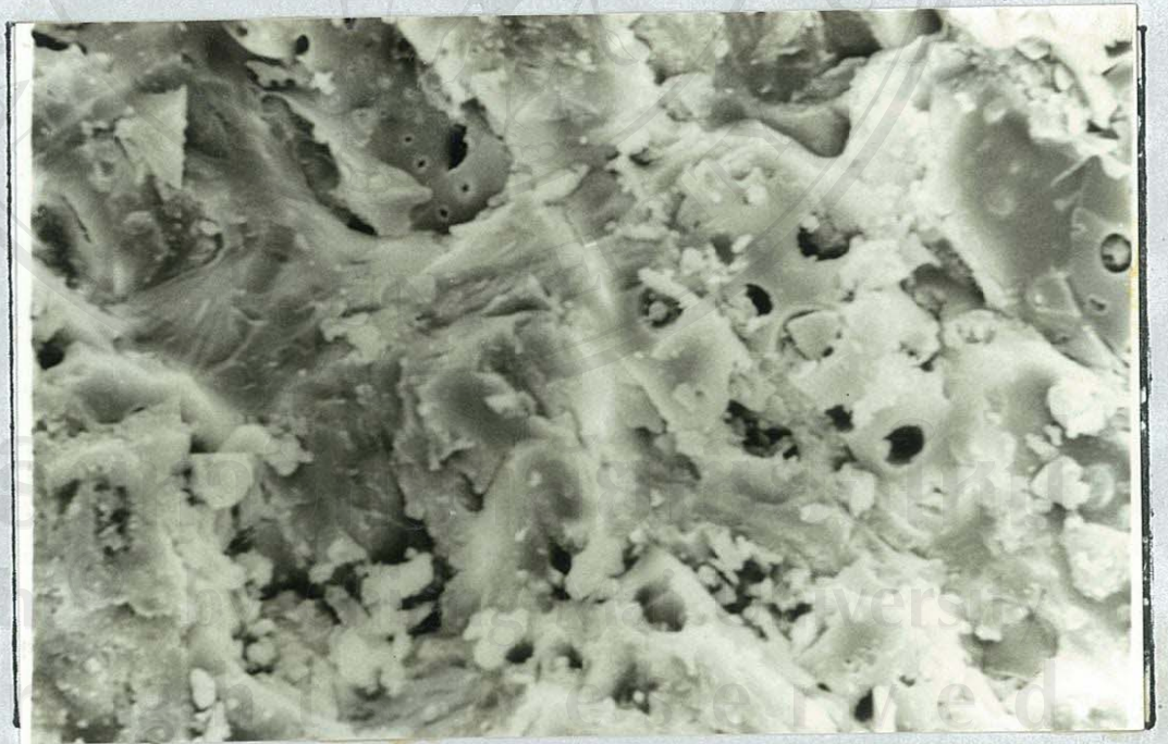
รูป 3.7 แสดงลักษณะถาดหินที่ผ่านขบวนการดีซัลเฟอร์ไรเซชันแล้ว แหล่งบ้านป่าคา
