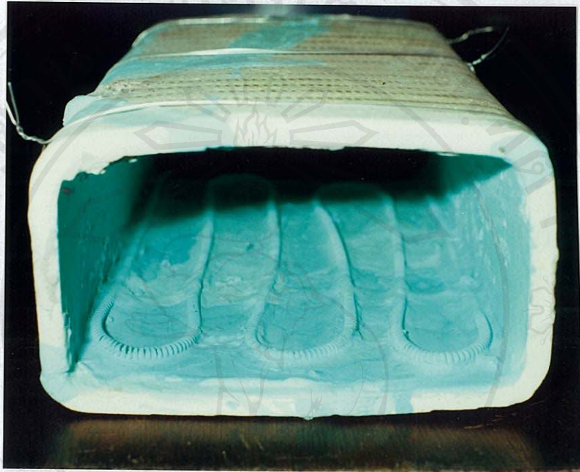
รูปที่ 3.2 นำเส้นลวดความร้อนติดที่ผนังเซรามิกส์ของเตา
