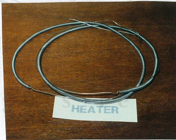
รูปที่ 3.1 เส้นลวดที่นำมาพันเป็นรูปคอลล์
