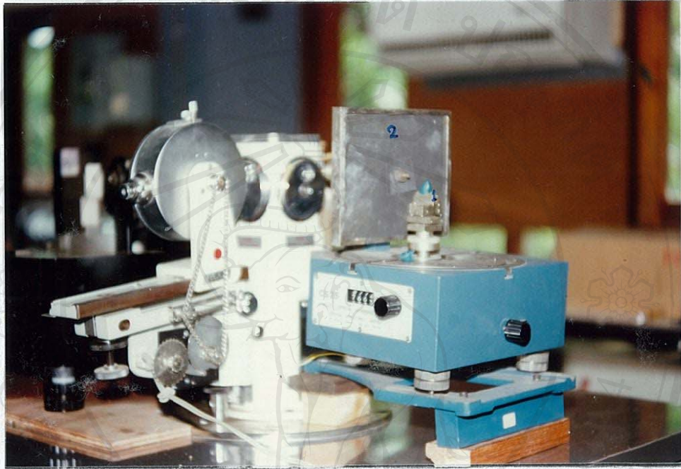
รูปที่ 3.5 แสดงการตั้ง specimen และแกนหมุนปรับการถ่ายภาพ Laue 1 ที่ตั้ง Specimen 2 फिल्मถ่ายภาพ Back Reflection
