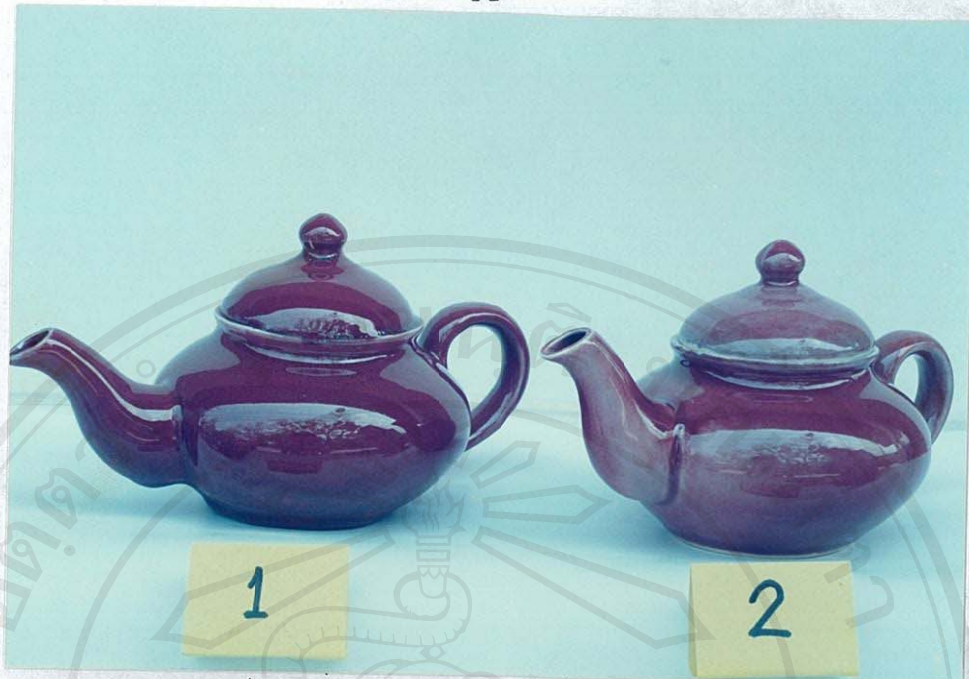
รูป ก.5 ผลิตภัณฑ์เซรามิกเคลือบของทองแดงกลุ่มที่ 1 สูตร 4 ที่ 1220 °C, RF 1. ใช้ไนเตรสเฟลสปาร์ 2. ใช้โซดาเฟลสปาร์
