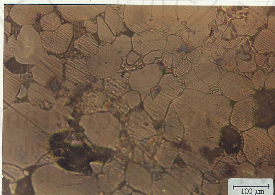
รูปที่ 4.26 จ. Microstructure ของสาร \text{BaTiO}_3 เจือด้วย Dy 0.8 mol%
