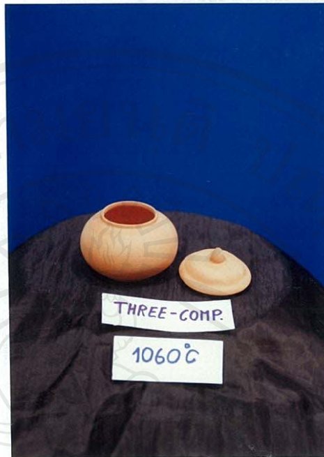
รูป 3.33 ผลการทดลองผลิตภัณฑ์ดินหางดง+ดินเบา+หินโดโลไมต์ อัตราส่วน 60:10:30 เเผาที่ อุณหภูมิ 1060°C
