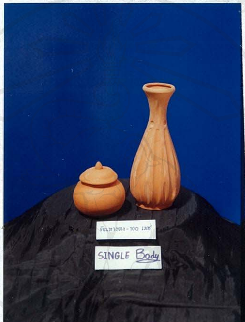
รูป 3.15 ผลการทดลองผลิตภัณฑ์ดินทางดง -100 เมช เผาที่อุณหภูมิ 1060 °C
