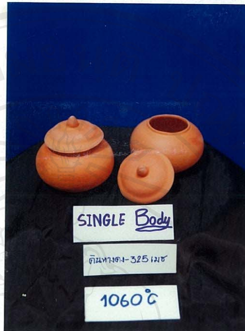
รูป 3.17 ผลการทดลองผลิตภัณฑ์ดินทางดงเผาที่ -325 อุณหภูมิ 1060 °C
