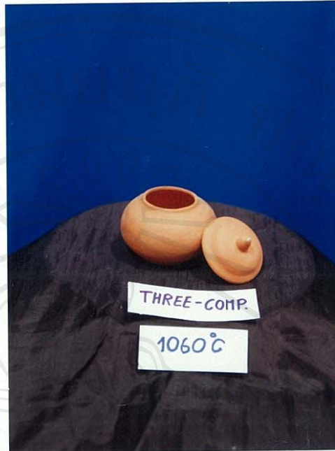
รูป 3.31 ผลการทดลองผลิตภัณฑ์ดินหางดง+ดินเบา+หินโดโลไมต์ อัตราส่วน 70:10:20 เผาที่ อุณหภูมิ 1060°C
