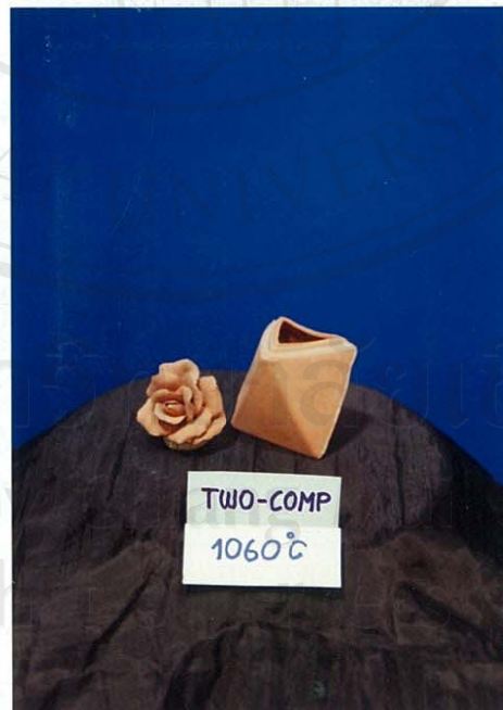
รูป 3.20 ผลการทดลองผลิตภัณฑ์ดินทางคง+ดินผสมโดโลไมต์อัตราส่วน 80:20 เเผาที่ อุณหภูมิ 1060°C
