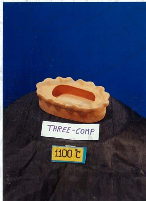
รูป 3.27 ผลการทดลองผลิตภัณฑ์ดินทางดง+ดินลำปาง+หินปูน อัตราส่วน 80:10:10 เผาที่อุณหภูมิ 1100°C
