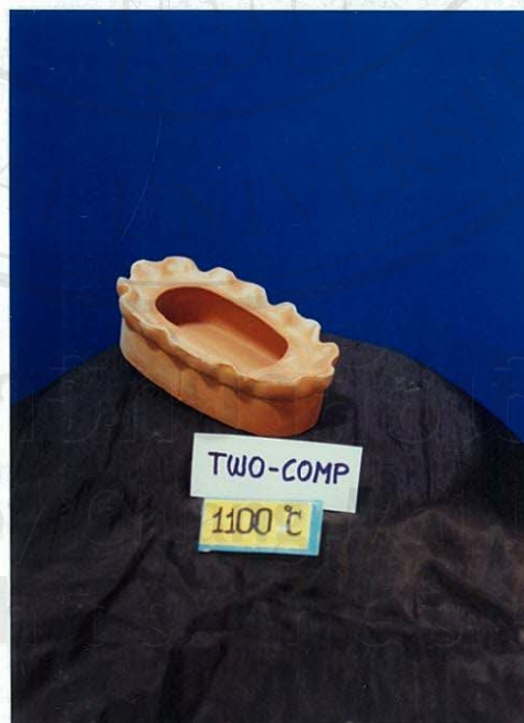
รูป 3.24 ผลการทดลองผลิตภัณฑ์ดินหางดง+ดินขาวลำปางอัตราส่วน 50:50 เเผที่อุณหภูมิ 1100°C
