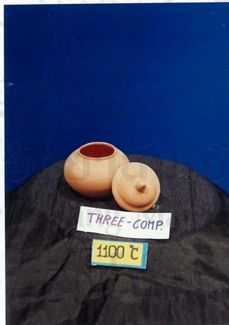
รูป 3.34 ผลการทดลองผลิตภัณฑ์ดินหางดง+ดินเบา+หินโดโลไมต์ อัตราส่วน 60:10:20 เเผาที่ อุณหภูมิ 1100°C
