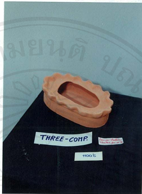
รูป 3.27 ผลการทดลองผลิตภัณฑ์ดินทางดง+ดินลำปาง+หินปูน อัตราส่วน 80:10:10 เผาที่อุณหภูมิ 1100°C
