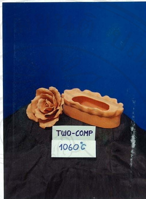
รูป 3.19 ผลการทดลองผลิตภัณฑ์ดินทางคง+ซีเถ้ากระดูกอัตราส่วน 50:50 เเผาที่อุณหภูมิ 1060°C
