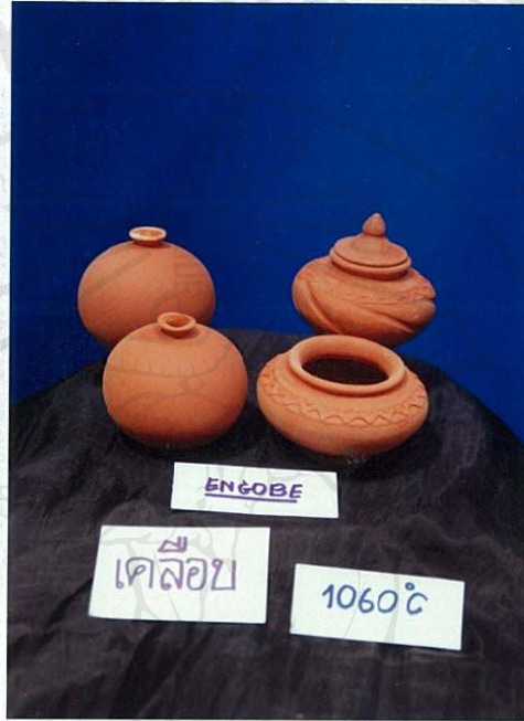
รูป 3.39 ผลการทดลองนำผลิตภัณฑ์มาใช้กับเคลือบแบบ Engobe เผาที่อุณหภูมิ 1060 °C
