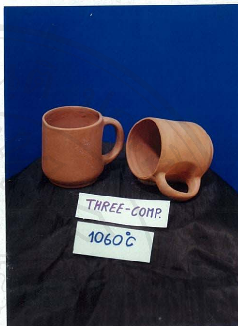
รูป 3.25 ผลการทดลองผลิตภัณฑ์ดินทางดง+ดินลำปาง+ \text{Fe}_2\text{O}_3 อัตราส่วน 50:50 +10% \text{Fe}_2\text{O}_3 additive เผาที่อุณหภูมิ 1060°C
