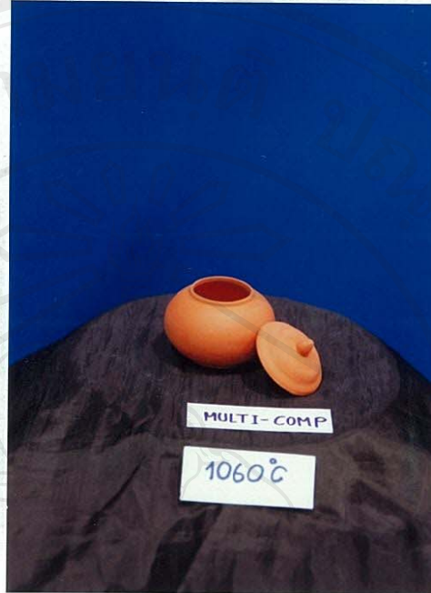
รูป 3.35 ผลการทดลองผลิตภัณฑ์ดินหางดง+ซีเถ้ากระดูก+ดินเบา+Calcine kaoline+frit No.633 อัตราส่วน 65:17:10:3:5 เเผาที่อุณหภูมิ 1060°C
