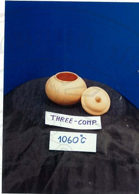
รูป 3.29 ผลการทดลองผลิตภัณฑ์ดินหางดง+ดินเบา+หินโดโลไมต์ อัตราส่วน 70:20:10 เผาที่อุณหภูมิ 1060°C
