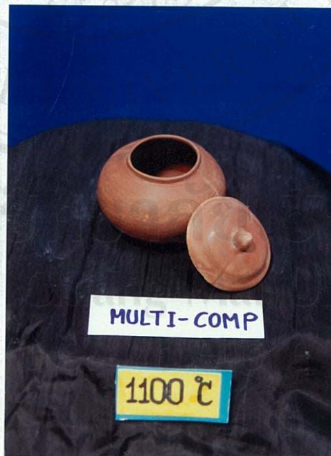
รูป 3.36 ผลการทดลองผลิตภัณฑ์ดินหางดง+ซีเถ้ากระดูก+ดินเบา+Calcine kaoline+frit No.633 อัตราส่วน 65:17:10:3:5 เเผาที่อุณหภูมิ 1100°C
