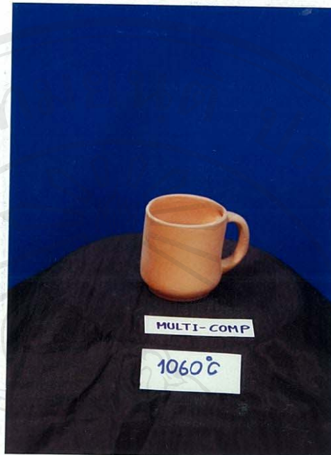
รูป 3.37 ผลการทดลองผลิตภัณฑ์ดินหางดง+ดินลำปาง+หินฟันม้า+ควอทซ์+ทลคัม อัตราส่วน 45:35:8:7:5 + 10% ดินแดงดอยสะเก็ดเป็น additive เผาที่อุณหภูมิ 1060°C
