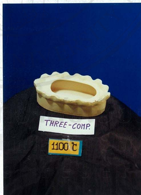
รูป 3.26 ผลการทดลองผลิตภัณฑ์ดินทางดง+ดินลำปาง+หินปูน อัตราส่วน 50:10:40 เผาที่อุณหภูมิ 1100°C
