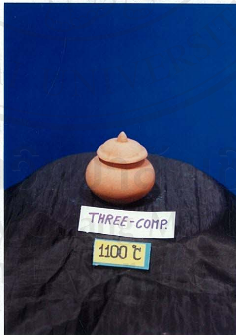
รูป 3.32 ผลการทดลองผลิตภัณฑ์ดินหางดง+ดินเบา+หินโดโลไมต์ อัตราส่วน 70:10:20 เผาที่ อุณหภูมิ 1100°C
