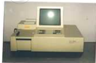
ภาพที่ 9 อุปกรณ์ในการวิเคราะห์คลอโรฟิลล์ เอ (spectrophotometer UV-160A)
