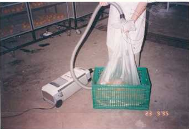
รูปที่ ก-3 ก๊าซดูดเอาอากาศปกติออกเพื่อให้เกิดสภาวะสุญญากาศ
