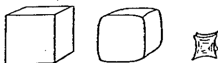
รูปที่ 2.24 รูปร่างของชิ้นอาหารก่อนและหลังการอบแห้ง (Potter, 1968)
