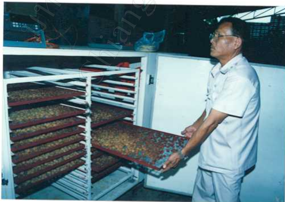
ภาพที่ 4 แสดงลักษณะภายในเตาอบแบบ Cabinet dryer
