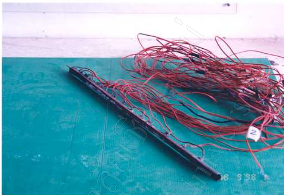
รูป 3.9 เครื่องมือสำหรับวัดอุณหภูมิที่ส่วนควบแน่น
