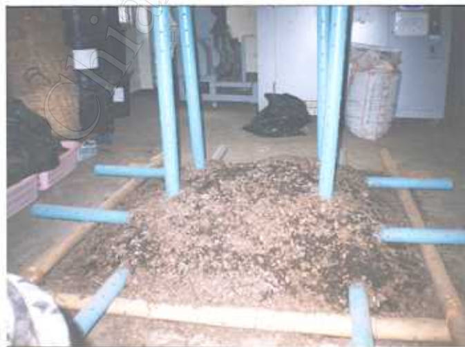
รูปที่ 41 สภาพของกองปุ๋ยหมักที่มีความสูง 1.0 ม. เมื่อสิ้นสุดกระบวนการหมักแล้ว
