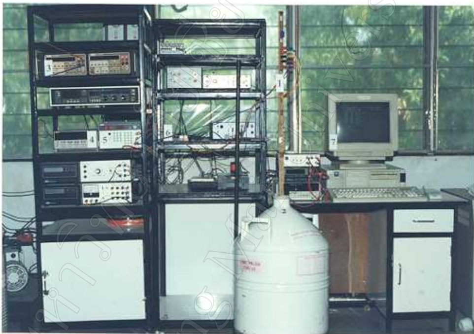
รูปที่ 3.6 แสดงอุปกรณ์ที่ใช้ในการวัดความหนาแน่นกระแสลัดของผลึกตัวอย่าง
