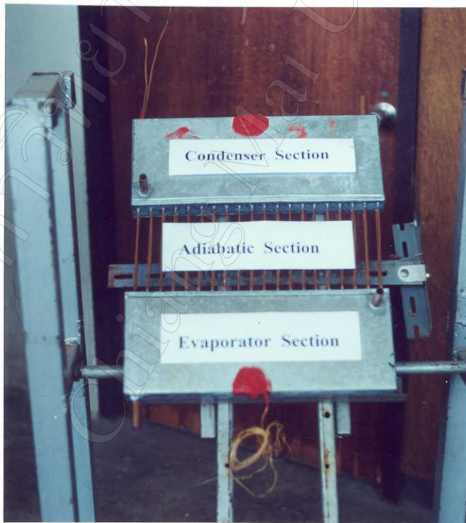
รูปที่ 3.2 ท่อความร้อนแบบสันปลายปิดที่ติดกล่องความร้อน และกล่องความเย็น
