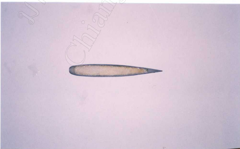
รูปที่ ข-10 แสดงภาคหน้าตัดของปีกที่สร้างขึ้นเพื่อทดสอบในครั้งนี้
