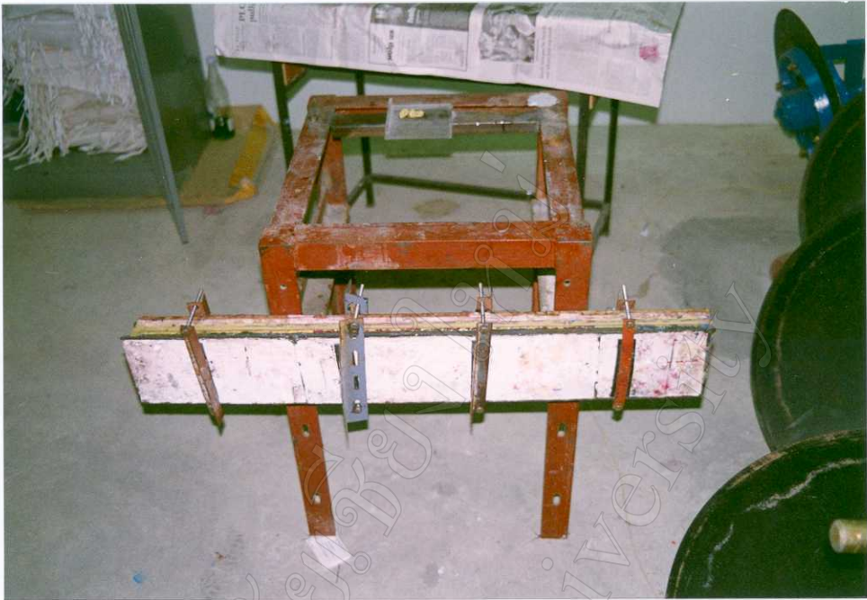
รูปที่ ข-7 แสดงพิมพ์ที่ประกบแล้ววางในแนวระดับเพื่อเทเรซินเชื่อมผิวปีก
