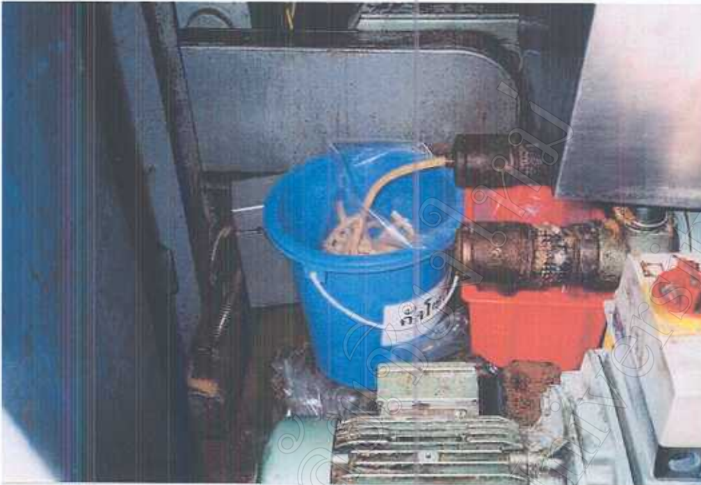
รูปที่ 4.3 การสกัดน้ำมันถั่วเหลืองด้วยเครื่องบีบอัดแบบสกรู
