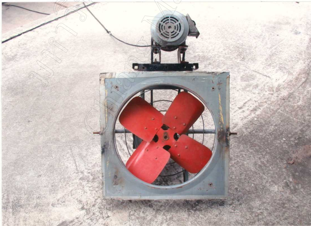
รูป 3.7 พัดลมดูดอากาศ
