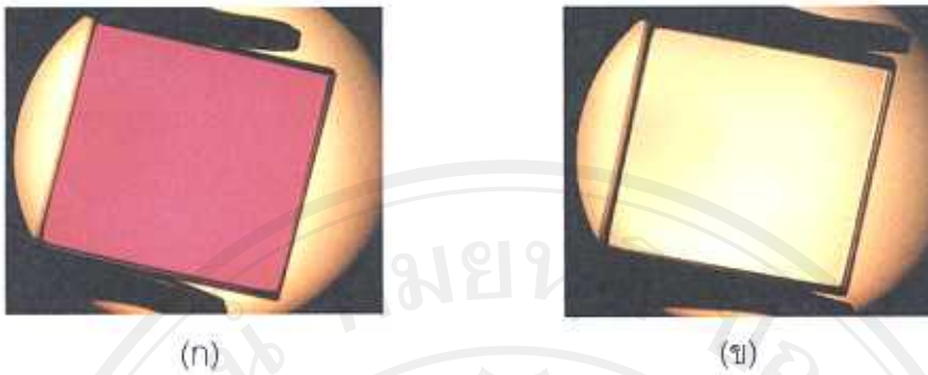
รูป 3.1 ลักษณะตัวอย่างก่อนการฝังไอออน (ก) ทับทิมสังเคราะห์ (ข) แชนไฟร์สังเคราะห์ กำลังขยาย 16 เท่า
