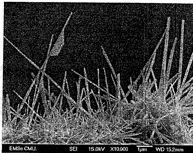
รูป 4.13 ภาพถ่าย SEM กำลังขยาย 10,000 เท่าแสดงพื้นผิวของลวดทั้งสแตนที่นำไปทำการทดลองที่ อุณหภูมิ 800 เคลวิน และอัตราการไหลของก๊าซอะเซทิลีนและอาร์กอน เป็น 0.1 และ 10 มล.ต่อวินาที ตามลำดับ
