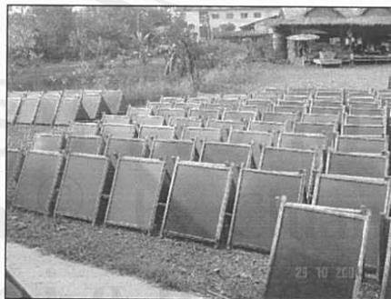
ภาพที่ 4.15 การตากแดดของแผ่นกระดาษสาบนตะแกรง
