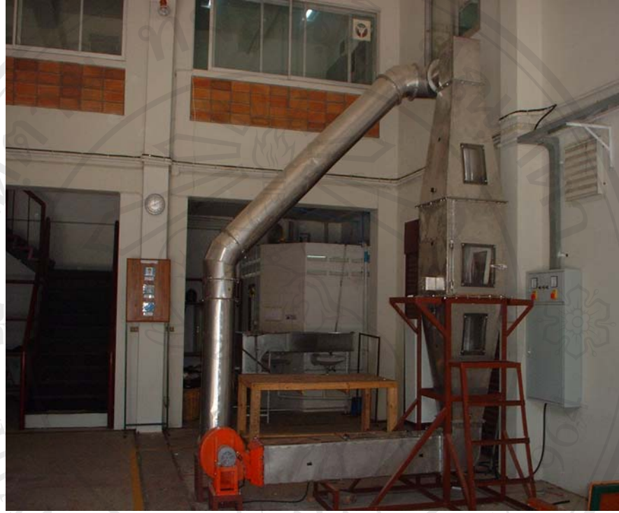
รูป ก.1 เครื่องอบแห้งแบบตู้ที่มีการนำความร้อนทิ้งกลับมาใช้ใหม่
