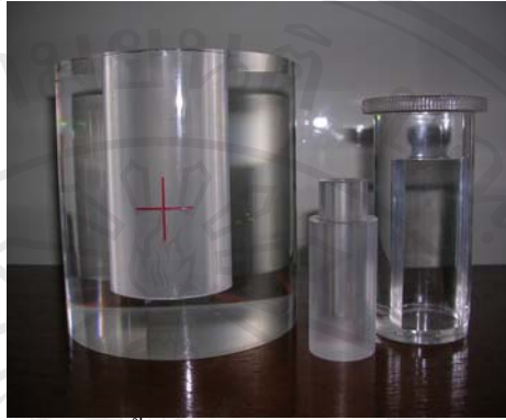
รูป 3.3 วัสดุสมมูลเนื้อเยื่อของคอแทนตำแหน่งต่อมไทรอยด์ รุ่น 5230-0038 บริษัทคาป็นเทค สำหรับทำไทรอยด์ออฟเทค
