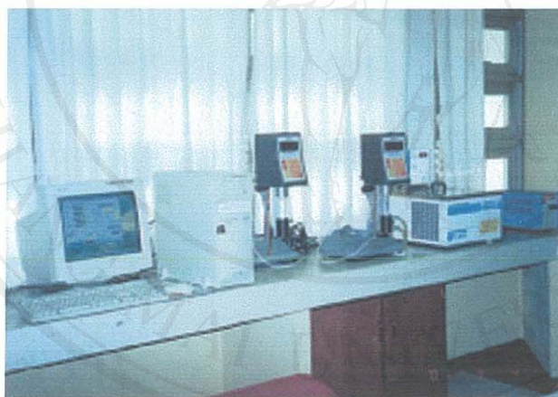
ภาพ 5 เครื่องมือวัดความหนืดบรูคฟิลด์วิสโคมิเตอร์ (brookfield viscometer)
