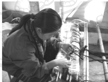
รูปภาพ 2.19 ขั้นตอนการเก็บลายลงบนอุปกรณ์ทอผ้า
