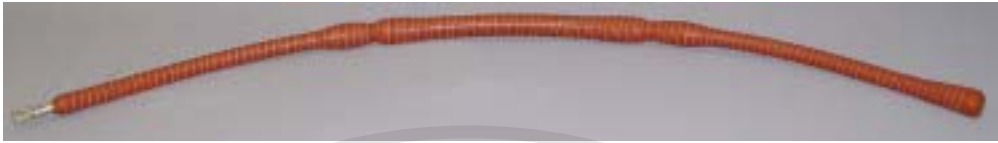
รูปที่ 5.17 ตัววัดการปล่อยประจุบางส่วนทำด้วยสายเคเบิลแรงดันสูง[บริษัท Iris Engineerring]
