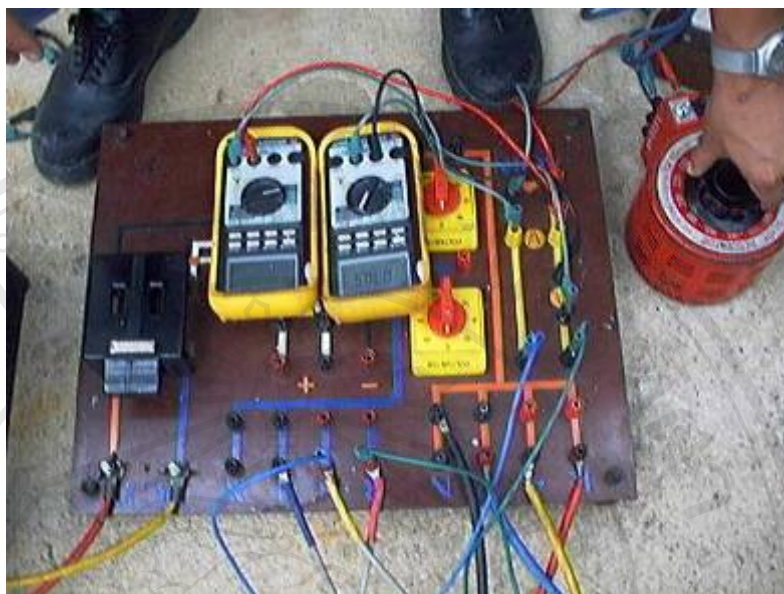
รูปที่ 5.7 วงจรทดสอบวัดค่าอิมพีแดนซ์ของขดลวด [7]
