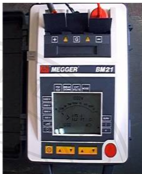
รูปที่ 5.2 การทดสอบความต้านทานของฉนวน [7]
