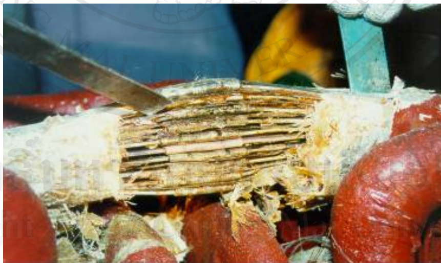
รูปที่5.5 การคลายของจุดต่อที่ขดลวดสเตเตอร์ของโรงไฟฟ้าพลังน้ำเขื่อนท่าทุ่งนาหน่วยที่1
