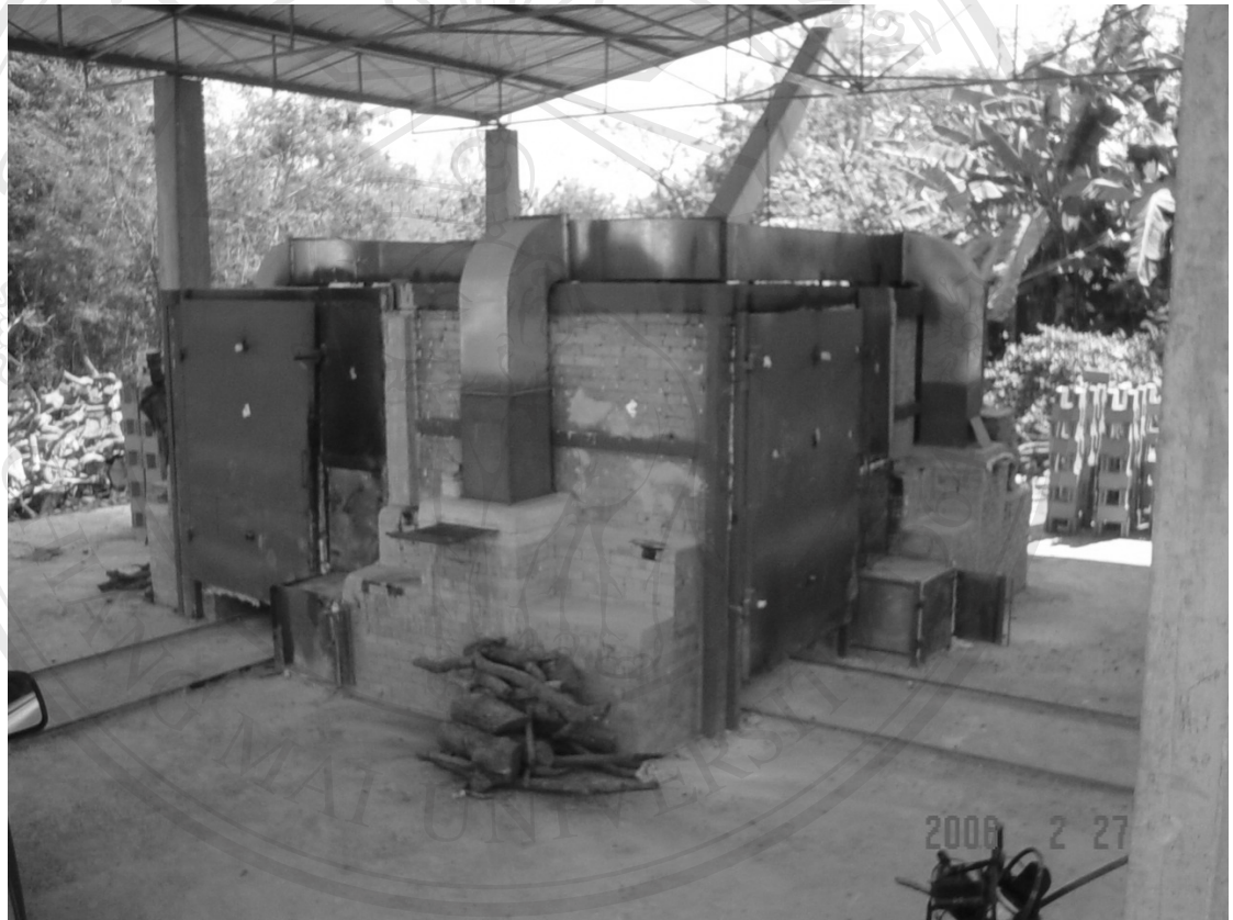
รูปที่ ข.1 เตาเผาอิฐแบบประหยัดพลังงาน 4 ห้องเผา
