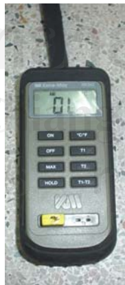
รูปที่ 3.8 เครื่องอ่านอุณหภูมิแบบดิจิทัล Digital thermometer รุ่น KM330 บริษัท Kane-May
