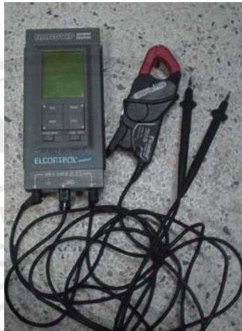
รูปที่ 3.17 เครื่องวัดกำลังไฟฟ้า Nanovip-Nanovip Plus
