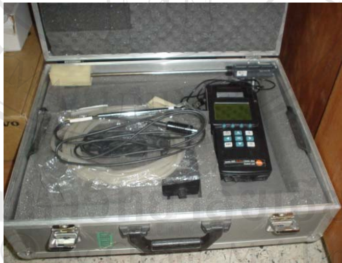
รูปที่ 3.14 เครื่องมือวัดความเร็วม รุ่น 350/335 M/XL
