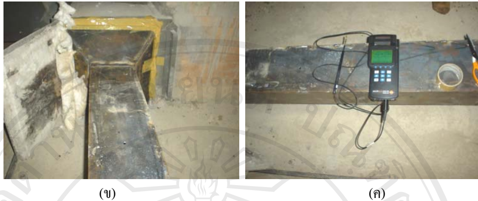
รูปที่ 3.13 แสดงการติดตั้งเครื่องมือและท่อวัดความเร็วม (ก) ท่อวัดความเร็วม, (ข) การต่อท่อวัดความเร็ว, (ค) เครื่องมือวัดความเร็วม
