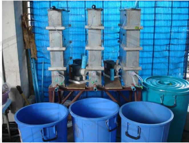
รูป 3.3 แบบจำลองระบบจัดเรียงดินหลายชั้น
