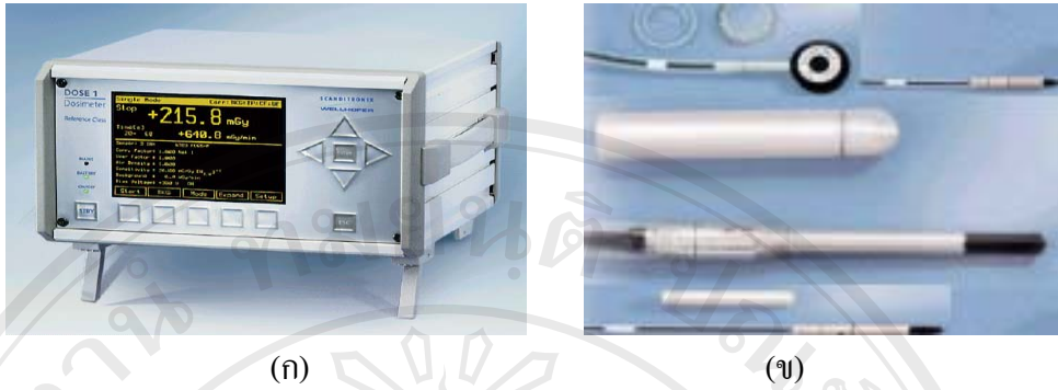
รูป 2.11 เครื่องมือตรวจวัดปริมาณรังสี (ก) electrometers และ (ข) detectors ชนิดต่าง ๆ (สุพจน์ เอื้ออภิสิทธิ์วงศ์, 2548)
