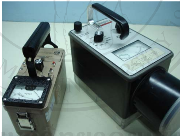
รูป 2.10 เครื่องตรวจติดตามวัดรังสี (survey meter)
