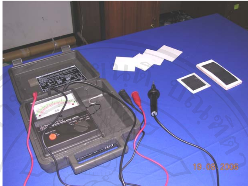
รูปที่ 3.24 อุปกรณ์ในการวัดความต้านทานของแผ่นอะลูมินา
