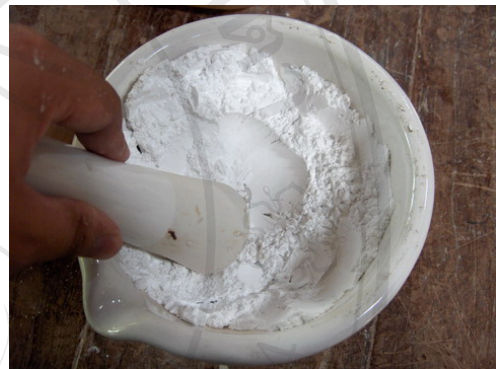
รูปที่ 3.11 การบดผสมกับสาร CMC
