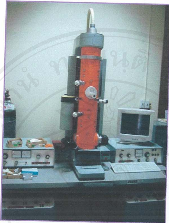
ภาพ 8 กล้องจุลทรรศน์อิเล็กตรอนแบบส่องผ่าน ยี่ห้อ ZEISS รุ่น EM 10 (ศูนย์วิจัยและบริการจุลทรรศน์อิเล็กตรอน คณะวิทยาศาสตร์ มหาวิทยาลัยเชียงใหม่)
