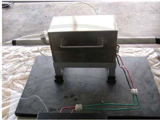
รูปที่ 3.12 อุปกรณ์ให้ความร้อนในการระเหิดโดยวิธีคาร์โบเทอร์มอล
