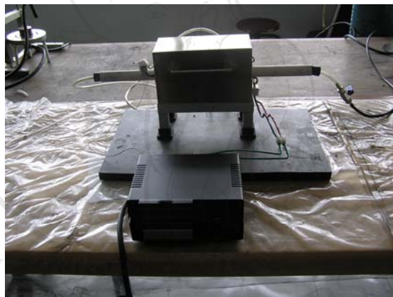
รูปที่ 3.13 แสดงการต่ออุปกรณ์การระเหิดโดยวิธีคาร์โบเทอร์มอล
