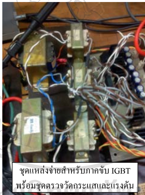
รูปที่ ง.7 ชุดแหล่งจ่ายสำหรับภาคขับ IGBT พร้อมชุดตรวจวัดกระแสและแรงดัน
