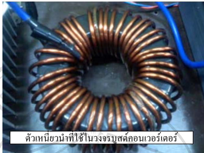
รูปที่ ง.6 ตัวเหนี่ยวนำที่ใช้ในของบูสต์คอนเวอร์เตอร์
