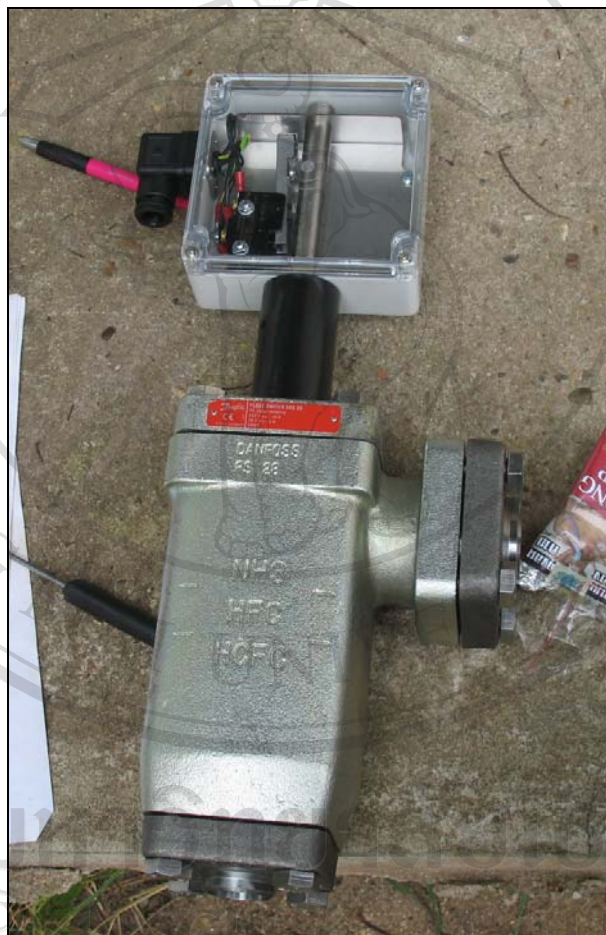
รูปที่ ๓.1 Float Switch สำหรับสารทำความเย็น
