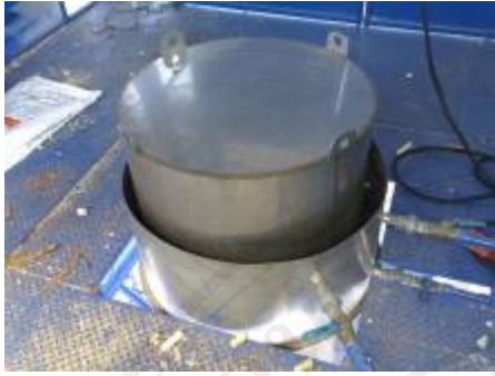
รูปที่ ก 3 (ฉ) ฝาปิดเตา Sealed ด้วยน้ำ
