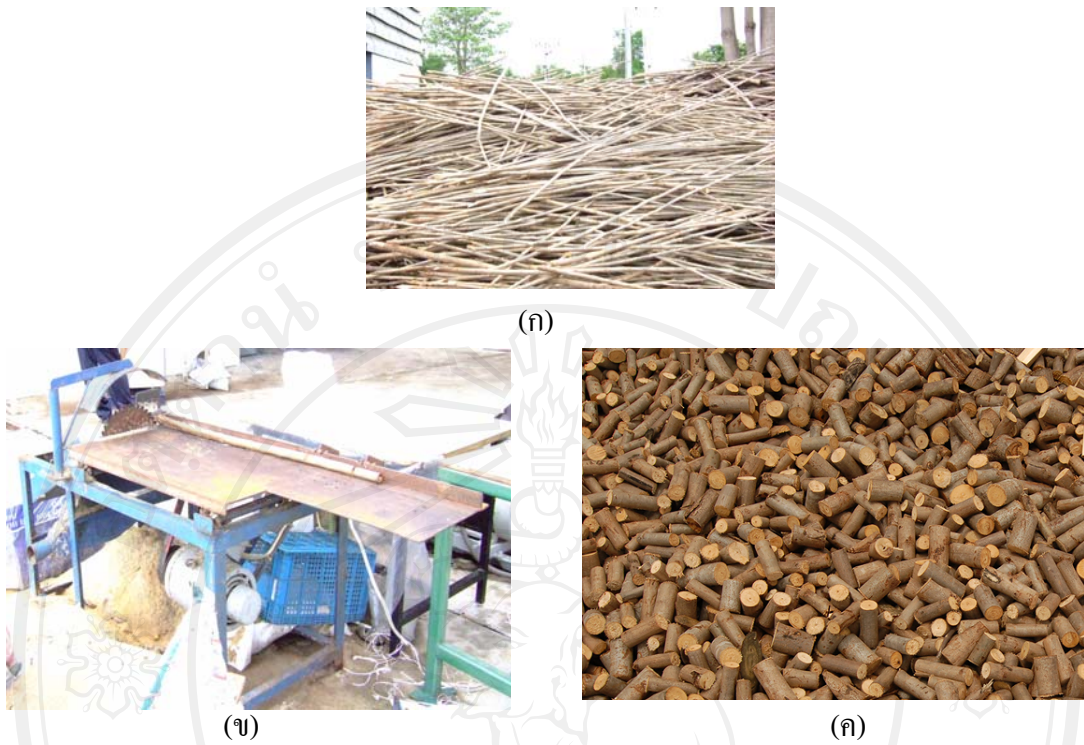
รูปที่ 3.3 ขั้นตอนการแปรรูป (ก) ไม้ซุง (ข) เครื่องหันไม้ (ค) ไม้เชื้อท่อนขนาด 5 เซนติเมตร
