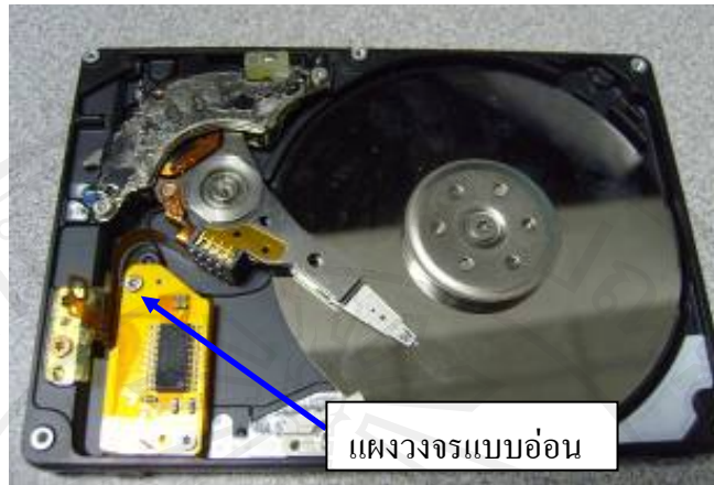
รูปที่ 1.2 แสดงผลิตภัณฑ์เมื่อประกอบเป็นหัวอ่านฮาร์ดดิสก์
