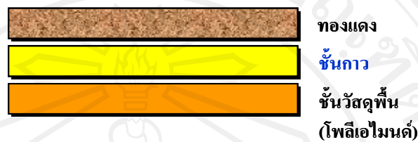
รูปที่ 2.6 แสดงโครงสร้างแผงวงจรแบบชั้นเดียว (บริษัทวิจัย, 2007)
