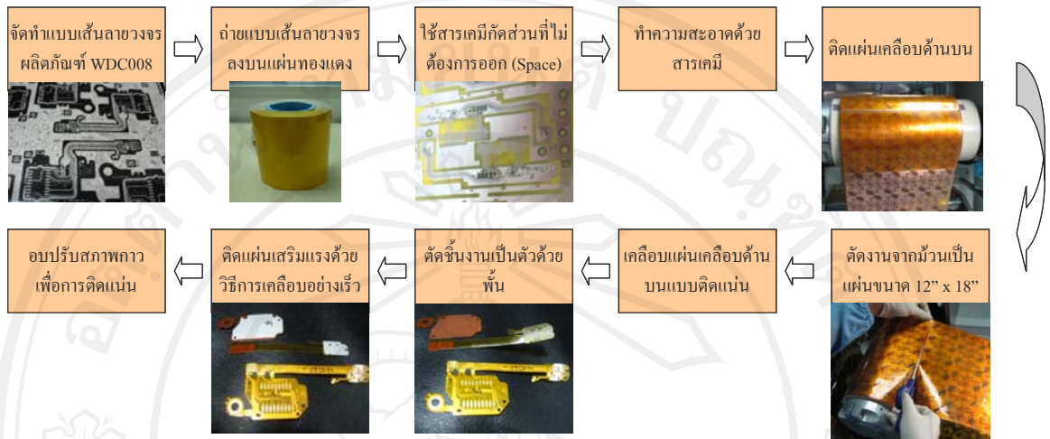
รูปที่ 2.10 แสดงผังการผลิตผลิตภัณฑ์แผงวงจรแบบอ่อนรุ่น WDC (บริษัทวิจัย, 2007)
