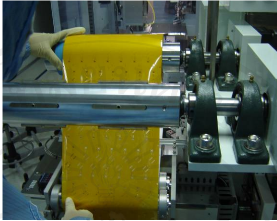
รูปที่ 4.5 แสดงแผ่นเคลือบด้านบนขนาด 2 นิ้ว x 250 มม.ตัดด้วยเครื่องอัตโนมัติ
