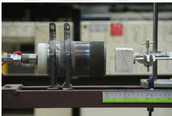
รูป 4.7 แสดงวิธีการวัดอุณหภูมิเปลวพลาสมาโดยใช้เทอร์โมคอปเปิล (Thermocouple)
