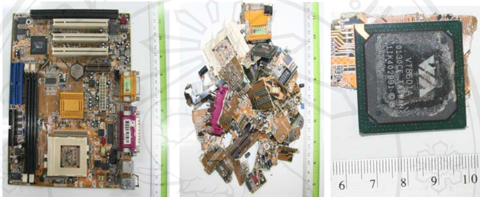
รูป 4.4 แผงวงจรคอมพิวเตอร์ที่ใช้เป็นขยะอิเล็กทรอนิกส์ตัวอย่าง ในการทดสอบประสิทธิภาพการเผาทำลายของหีบเผาพลาสติกแบบ
