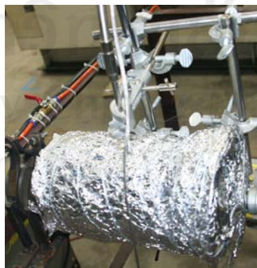
รูป 4.3 ห้องเผาจำลองที่ใช้ในการทดสอบการเผาทำลายขยะอิเล็กทรอนิกส์
