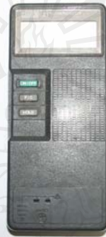
รูป 4.6 เครื่องอ่านอุณหภูมิระบบดิจิทัล ยี่ห้อ FLUKE 51 J/K ที่ใช้ในการอ่านค่าอุณหภูมิ
