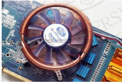
รูปที่ 1.1 แสดงการติดตั้งท่อความร้อนเพื่อระบายความร้อนให้กับอุปกรณ์อิเล็กทรอนิกส์
