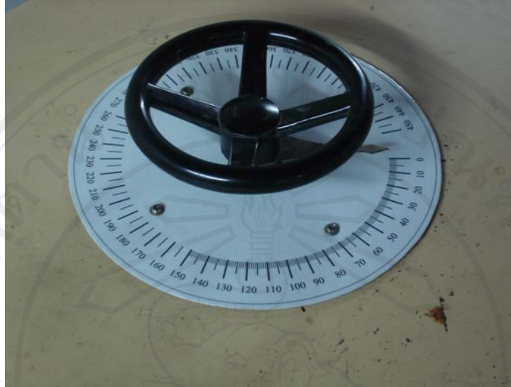
รูปที่ 3.8 ที่ปรับระดับความร้อนโดยผ่านการปรับที่ Variac
