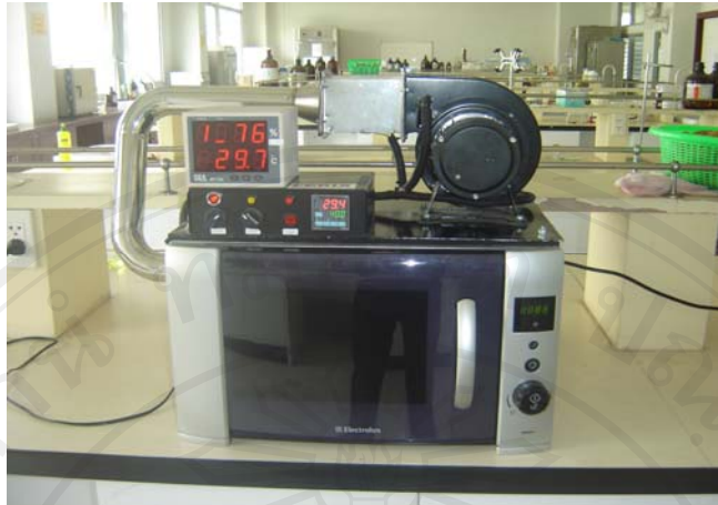
รูปภาคผนวก ก-1 เครื่องอบแห้งไมโครเวฟร่วมกับลมร้อน
