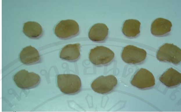
รูปภาคผนวก ก-7 เนื้อลำไยอบแห้งที่ได้จากการอบแห้งด้วยเครื่องไมโครเวฟร่วมกับลมร้อนที่กำลังงานไมโครเวฟ 100 วัตต์ อุณหภูมิลมร้อน 60 องศาเซลเซียส ความเร็วลมร้อน 5 เมตรต่อวินาที
