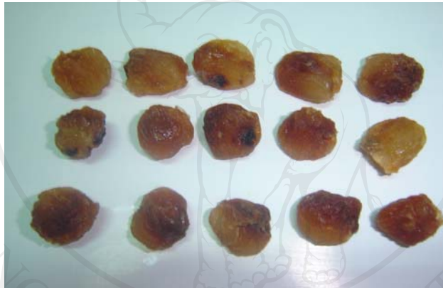
รูปภาคผนวก ก-11 เนื้อลำไยอบแห้งที่ได้จากการอบแห้งด้วยเครื่องไมโครเวฟร่วมกับลมร้อนที่ กำลังงานไมโครเวฟ 300 วัตต์ อุณหภูมิลมร้อน 60 องศาเซลเซียส ความเร็วลมร้อน 5 เมตรต่อวินาที
