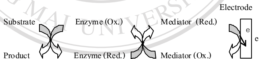
รูป 2.3 ลำดับขั้นตอนการเกิดปฏิกิริยาของ Amperometric biosensor
