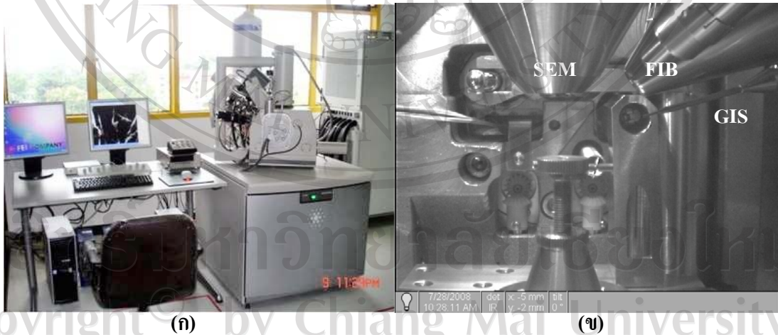
รูป 3.1 (ก) เครื่องโฟกัสไอออน빔, (ข) ส่วนประกอบภายในเครื่องโฟกัสไอออน빔
