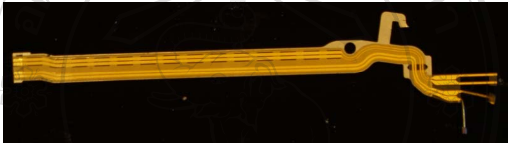
รูป 3.9 สายแพร์สำเร็จรูป จากฮาร์ดดิสก์คอมพิวเตอร์
