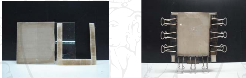
รูป 2.4 แม่พิมพ์ที่รองรับการสังเคราะห์ไฮโดรเจลในระบบปริเริ่มปฏิกิริยาพอลิเมอไรเซชันแบบแสงอัลตราไวโอเลต
