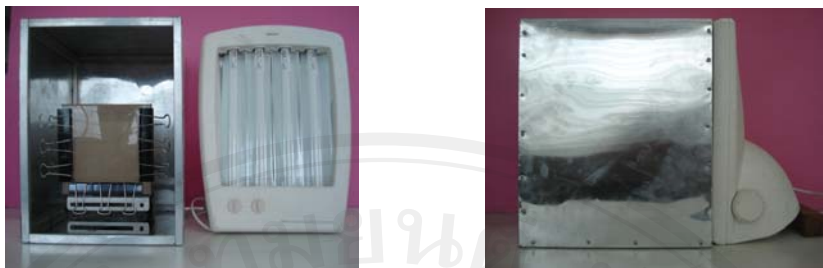
รูป 2.2 อุปกรณ์การสังเคราะห์ไฮโดรเจลในระบบริเริ่มปฏิกิริยาพอลิเมอไรเซชันแบบแสงอัลตราไวโอเลต
