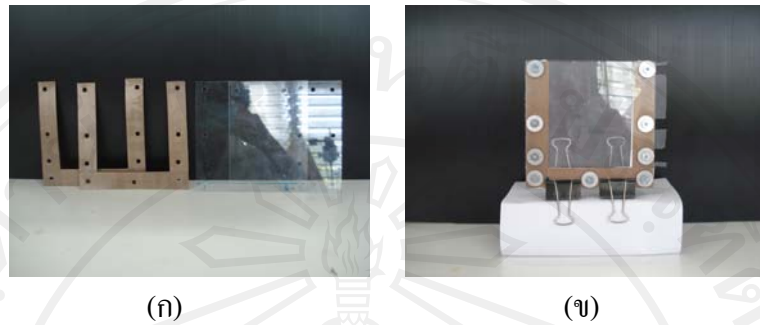
รูป 2.5 แม่พิมพ์แผ่นไฮโดรเจลที่รองรับการสังเคราะห์แบบใส่ตาข่ายพลาสติก
