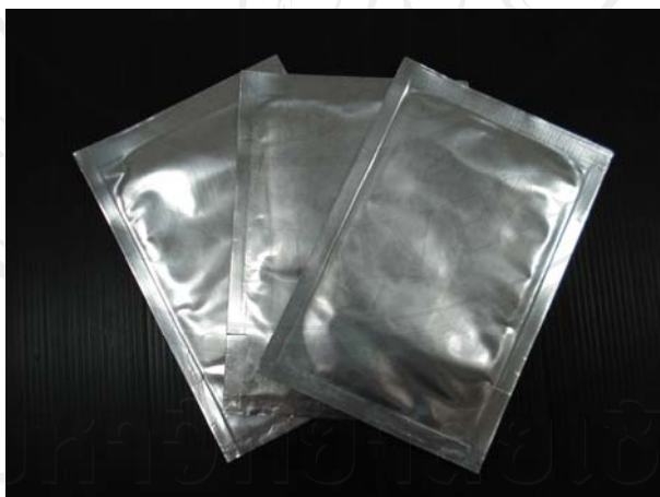
รูป 3.64 การบรรจุภัณฑ์ไฮโดรเจลตัวอย่างด้วยแผ่นอะลูมิเนียมหลังจากทำการปลดเชื้อด้วยรังสีแกมมา
