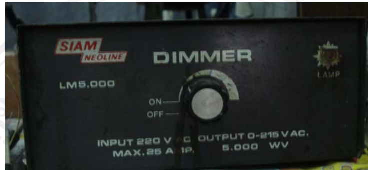
รูปที่ 3.5 ตัวปรับความสว่างของแสงอิเล็กทรอนิกส์
